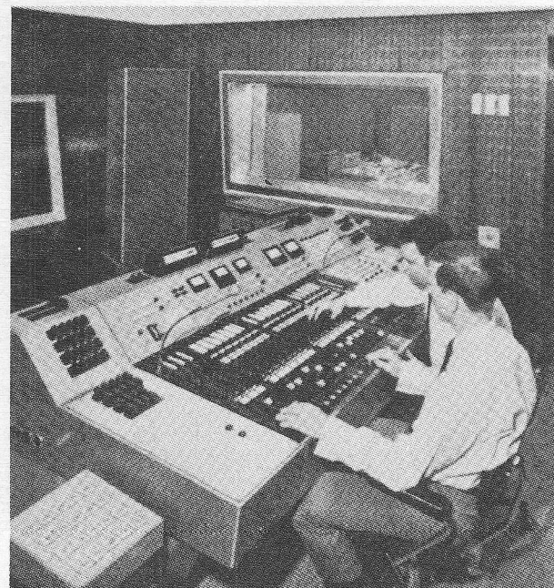
Compacte geluidsregietafel met de beide knoppenregisseurs
