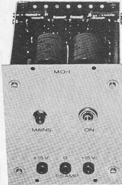
Het voedingsmoduul is kortsluitvast door stroombegrenzing.
